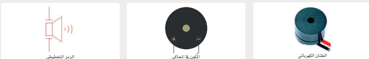
شكل 5.5: الطنان الكهربائي
