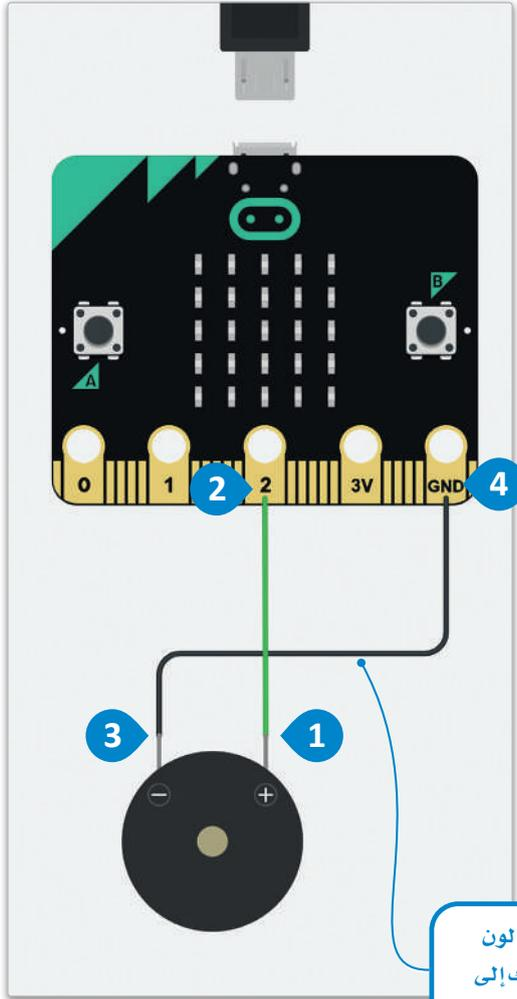
شكل 5.25: توصيل الطنان الكهربيائي
