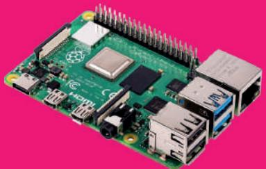
يرى البعض أن جهاز رازبيري باي (Raspberry Pi) هو جهاز تحكم دقيق مثل أردوينو (Arduino)، ويُعدُّ جهاز رازبيري باي بمثابة حاسوب صغير الحجم يمكن توصيله مباشرة بشاشة وملحقات إضافية أخرى مثل لوحة المفاتيح والفأرة، ويمكن أيضاً تحميل نظام تشغيل كامل عبر بطاقة ذاكرة محمولة (MicroSD Memory Card) في هذا الجهاز.
