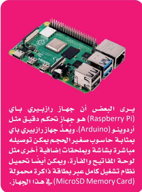
يرى البعض أن جهاز رايزبيري باي (Raspberry Pi) هو جهاز تحكم دقيق مثل أردوينو (Arduino)، ويُعدُّ جهاز رايزبيري باي بمثابة حاسوب صغير الحجم يمكن توصيله مباشرة بشاشة وبملحقات إضافية أخرى مثل لوحة المفاتيح والفأرة، ويمكن أيضاً تحميل نظام تشغيل كامل عبر بطاقة ذاكرة محمولة (MicroSD Memory Card) في هذا الجهاز.
