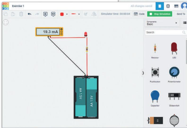
شكل 4.30: قياس التيار
