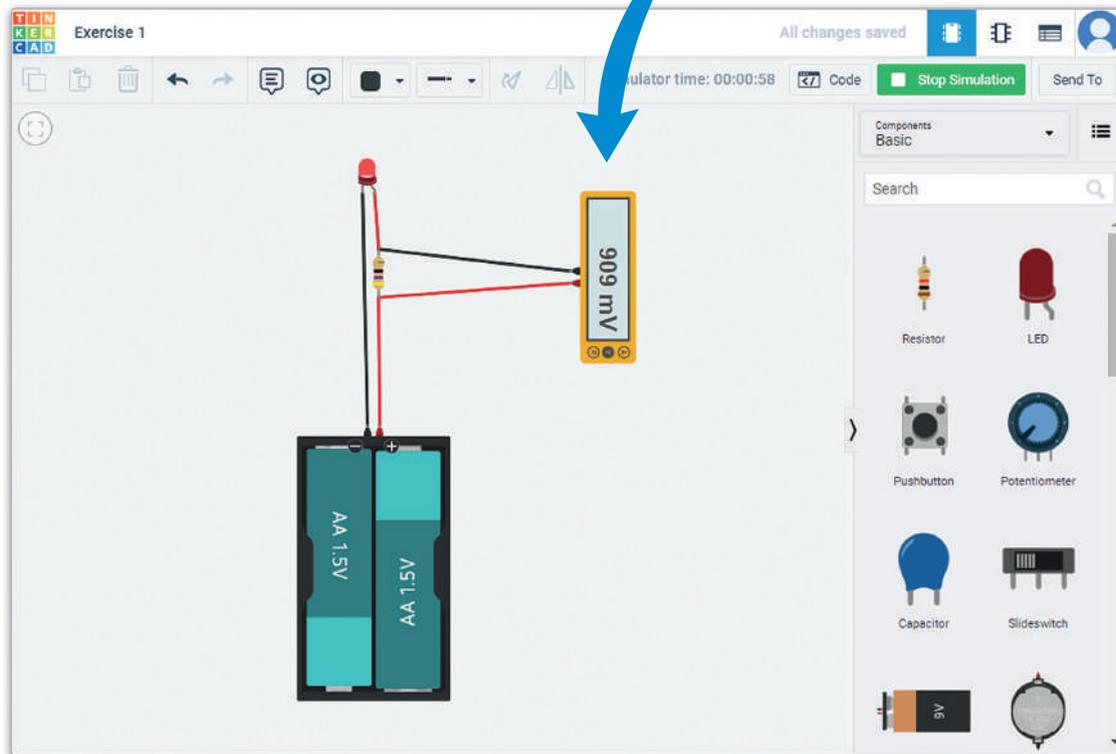
شكل 4.27: قياس فرق الجهد عبر طرفي المقاومة
