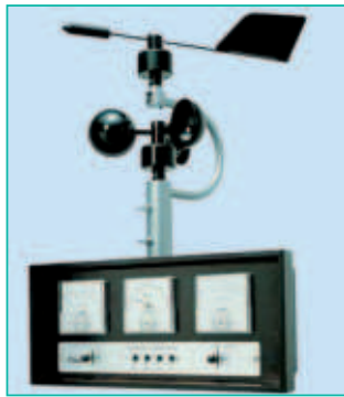
جهاز الأنيمومتر ودوارة الرياح
