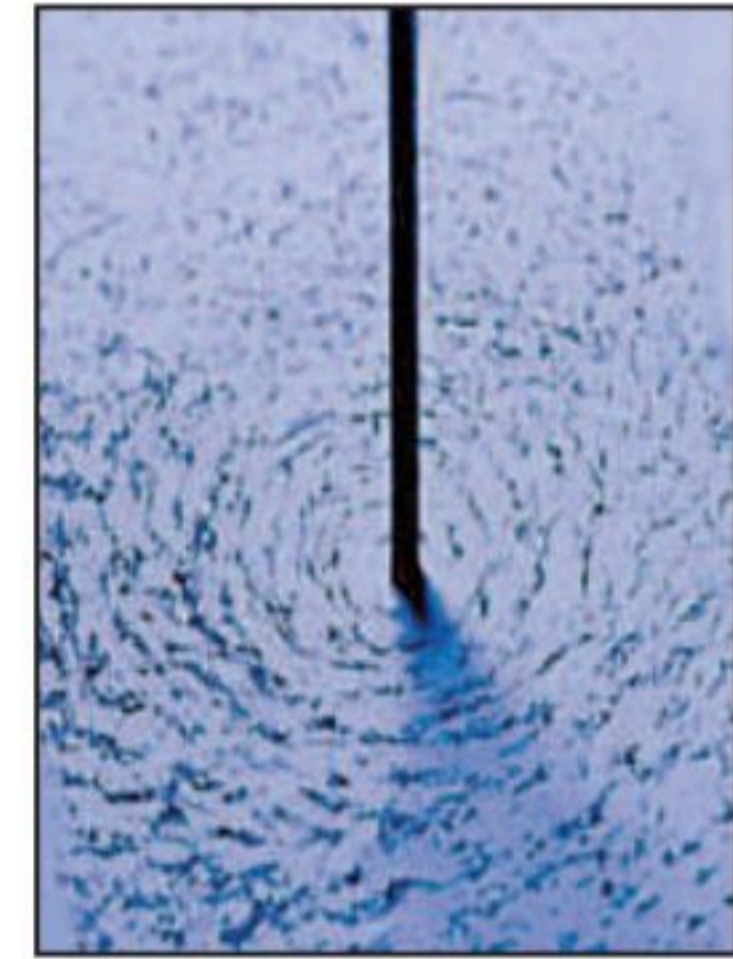
■ الشكل 6-9 يظهر المجال المغناطيسي حول سلك يمر فيه تيار كهربائي ويخترق قرصاً كرتونياً في صورة دوائر متحدة المركز من برادة الحديد حول السلك.
