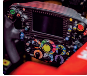
شكل 1.5: عجلة قيادة فورمولا 1 مثال مميّز للتصميم المرتكز على المُستخدم
