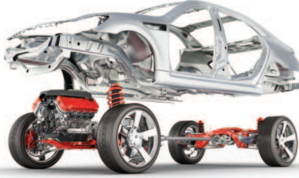
شكل 2.21: عرض تفصيلي لتجميع سيارة
