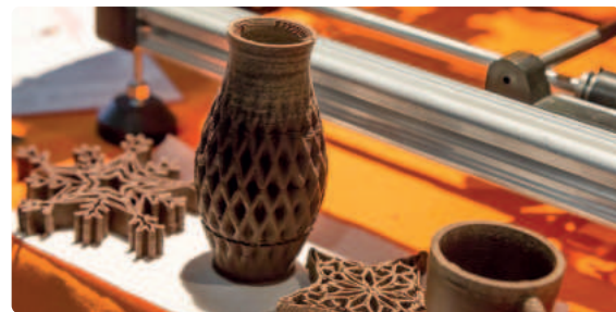
شكل 3.12: الطباعة ثلاثية الأبعاد بمادة السيراميك
