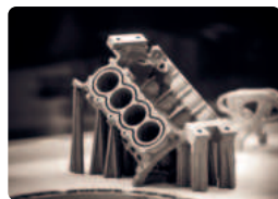
شكل 3.4: مجسم مطبوع بواسطة آلة تلييد بالليزر
