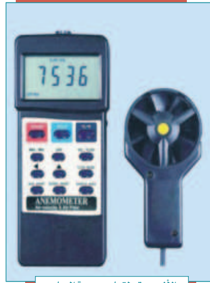
الأنيمومتر لقياس سرعة الرياح
