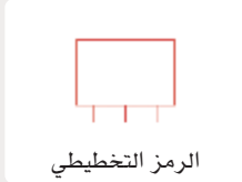
شكل 3.4: مُستشعر درجة الحرارة TMP36
