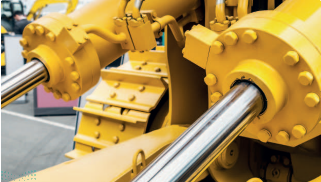
شكل 1.15: نظام مُشغّل هيدروليكي (مكبس) للآلات الثقيلة
