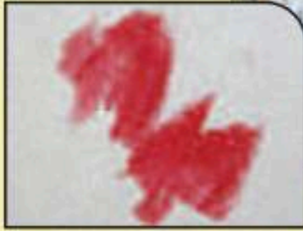
الشكل 2 هذه البقعة الحمراء لم يكن من الممكن إزالتها بالطرائق التقليدية، لكن الأكسجين الذري أزالها دون إتلاف اللوحة.
