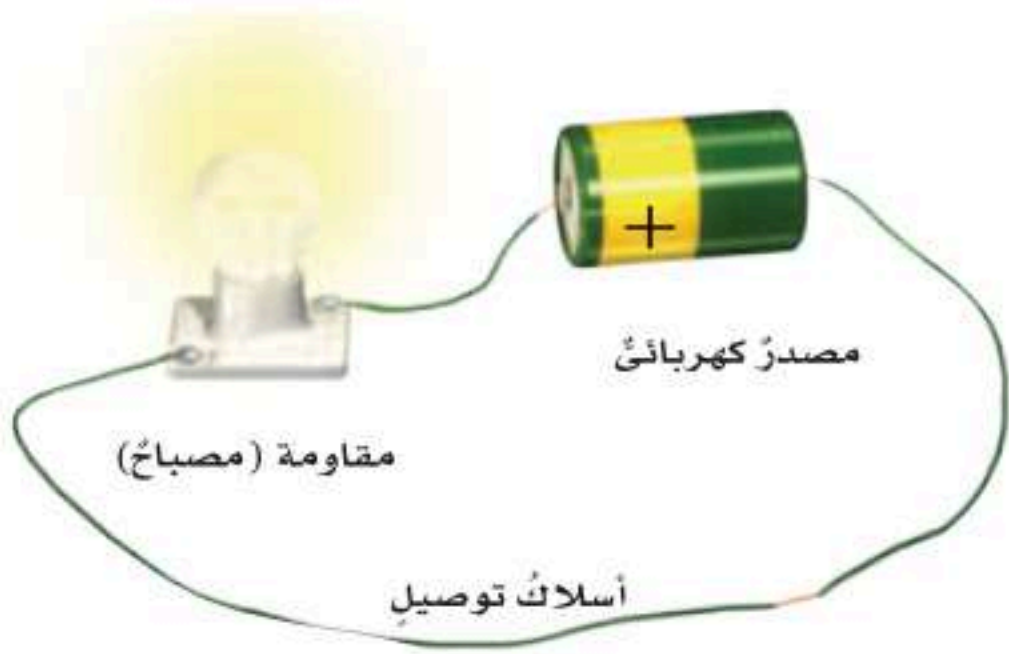
▲ أجزاء الدائرة الكهربائية.
