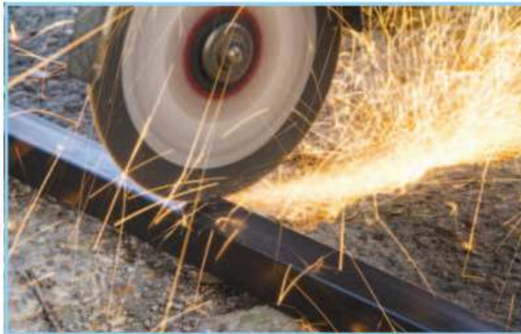
تحوّل الطاقة الحركية إلى طاقة حرارية بسبب الاحتكاك.
