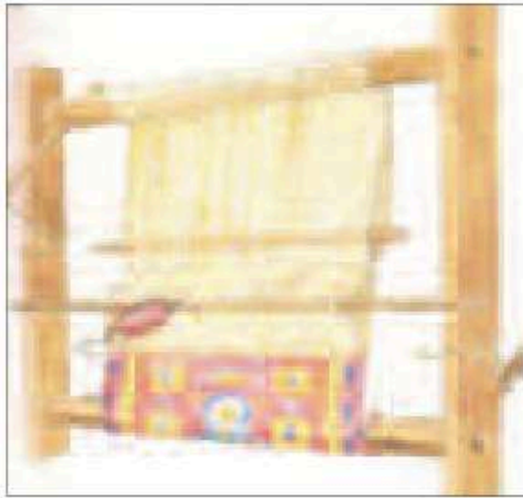
الشكل ( ٧٧ ) : نول الكليم ويلاحظ فيه تباعد خيوط السدى بما يتناسب مع التصميم المرسم.
