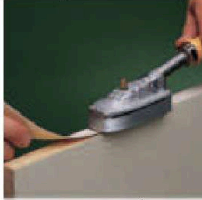
الشكل ( ٦١ ) : وتستخدم أيضاً لتغطية مساحات صغيرة كحواف الأخشاب .
