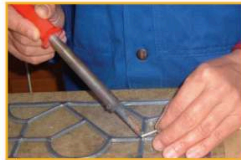
الشكل (٤٥): النوع الأول (لحام الانصهار باستخدام الطاقة الحرارية).
