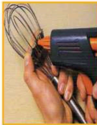
الشكل (٤٦): النوع الثاني (لحام البارد باستخدام الصمغ).
