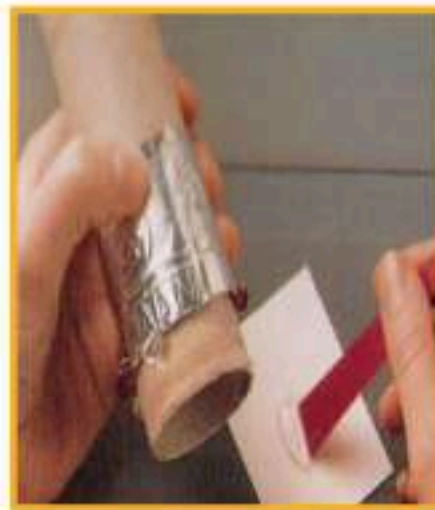
الشكل (٤٦): النوع الثاني (لحام البارد باستخدام الصمغ).
